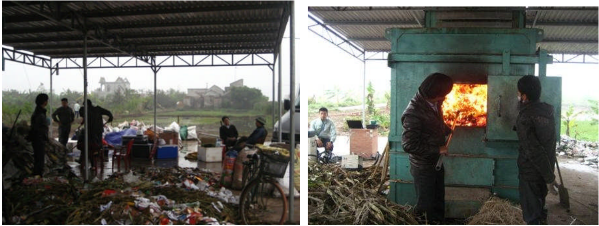
Hình 1. (a) Chất thải sinh hoạt đem đốt; (b) nạp rác và chất dễ cháy vào lò đốt
