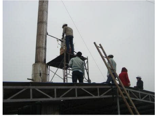
(a) Công tác thiết kế và chuẩn bị lấy mẫu khí thải lò đốt
